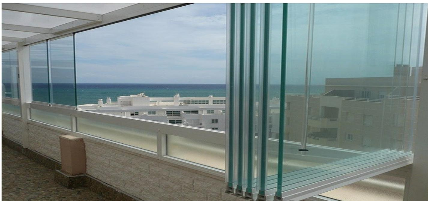
L'altezze delle chiusure scorrevoli in vetro possono variare da 1,5 metri a 2,6 metri. I vetri possono avere uno spessore di 8 o 10 mm.
